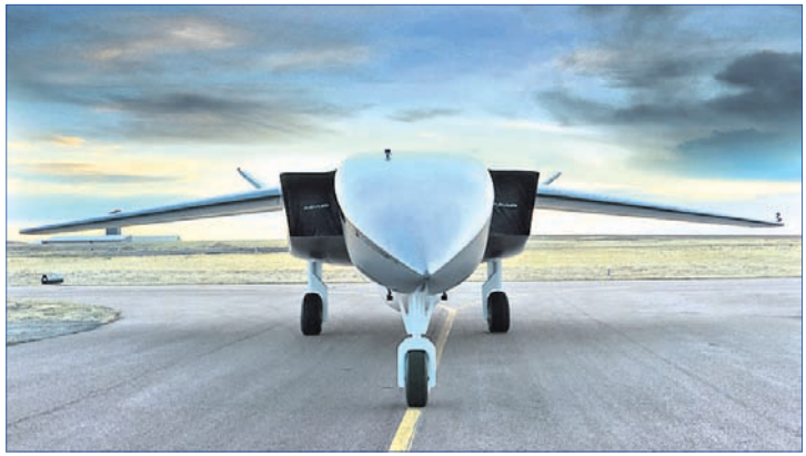
ବୋଲି କମ୍ପାନୀର ସିଇଓ ଜେ ସ୍ଟାଇଭଲ୍ କହିଛନ୍ତି। ସବୁଠାରୁ ବଡ଼ କଥା ଯେ, ଉପଗ୍ରହ ଉଦ୍ଦେଶ୍ୟପଣ ପାଇଁ ଲକ୍ଷ୍ୟପାତ୍ର ଭଳି ବ୍ୟୟବହୁଳ ଭିଡ଼ିଭୁମି ଏହା ଆବଶ୍ୟକ କରେ ନାହିଁ। ପାରମ୍ପରିକ ଜେଟ୍ ଇଞ୍ଜିନ ଏଥିରେ ବ୍ୟବହାର କରାଯାଇଛି। ପ୍ରତିକୂଳ ପାଣିପାଗରେ ମଧ୍ୟ ଏହି ଡ୍ରୋନ ସହଜରେ ଉଡ଼ାଣ ଓ ଲ୍ୟାଣ୍ଡିଂ କରିପାରିବ।
