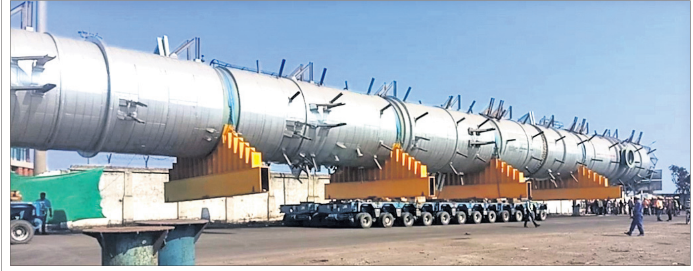
ପାରାଦୀପ ବନ୍ଦର ପିଆଇସିଟି(ପାରାଦୀପ ଇଣ୍ଡର ନ୍ୟାଶନାଲ କାର୍ଗୋ ଟର୍ମିନାଲ) ବର୍ଥରୁ ଟ୍ରେଲ ବିଶୋଧନାଗାର ଯାଏ ବିଶାଳ କାର୍ଗୋ ଓଡିସି(ଓଇ) ଟିମ୍ପେନଶନ କନସିଗ୍ନମେଣ୍ଟକୁ ରୁଧିରୀର ସ୍ଥାନାନ୍ତର କରାଯାଇଛି। ଏହାର ଓଜନ ୩୫୨୨ ମେଟ୍ରିକ୍ ଟନ୍। ଏଥିପାଇଁ ବେଲାଦୁଲି ରାସ୍ତାରେ ଥିବା ଆଲୋକାକରଣ ବିଦ୍ୟୁତ୍ ଖୁଣ୍ଟଗୁଡ଼ିକୁ ହଟାଇବାକୁ ହେବ।
